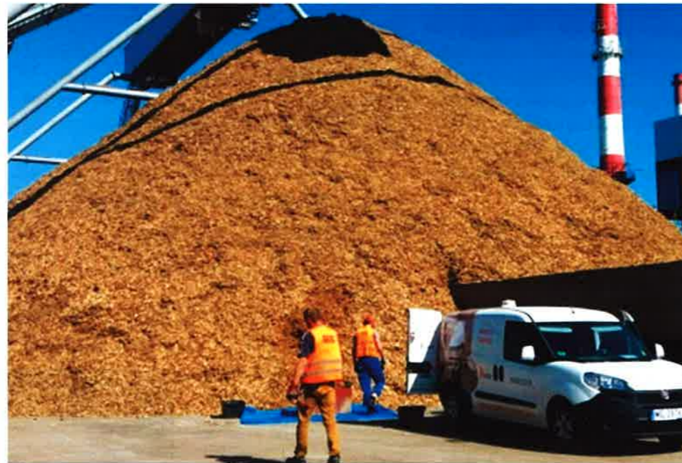
► Gęstość składowania jest różna w zależności od lokalizacji w hałdzie zarówno w stosunku do wysokości hałdy, jak i w stosunku do odległości od wysokości stożka będącego w uproszczeniu kształtem hałdy
