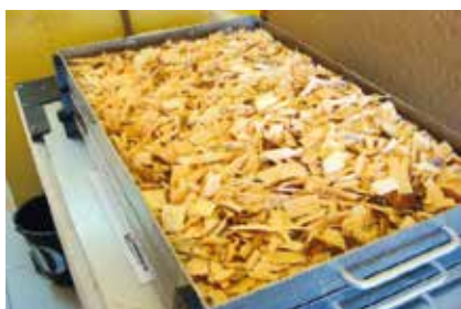
► Zdjęcia 6-8 Określanie frakcyjności zrębki metodą sitową
