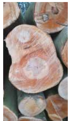
► Wielordzenność, zabitka, spłaszczenie, pęknięcie
